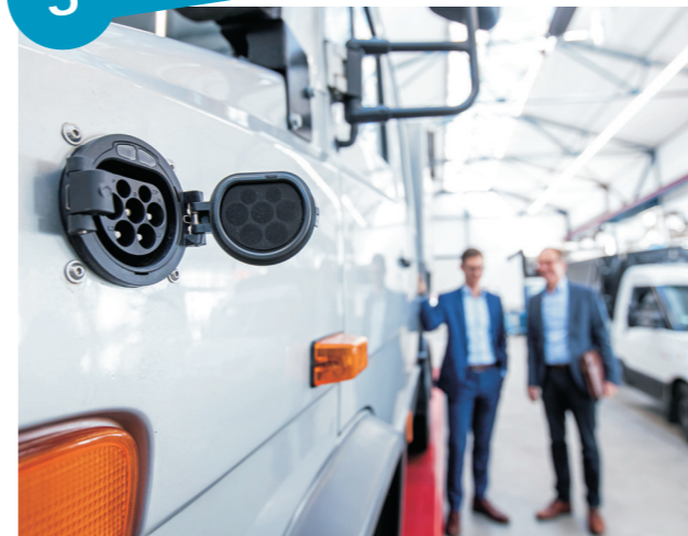
LKW-Steckdose eines eTransporters mit einer e-Achse der BPW Bergische Achsen KG, Wiehl ©Silvia Steinbach Fotodesign
